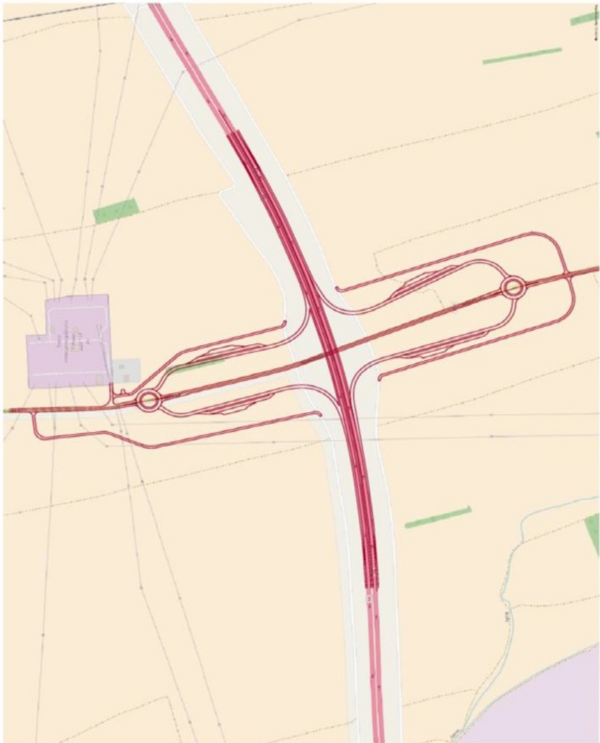
Rys. 3.1. Węzeł typu WB karo z rondami
