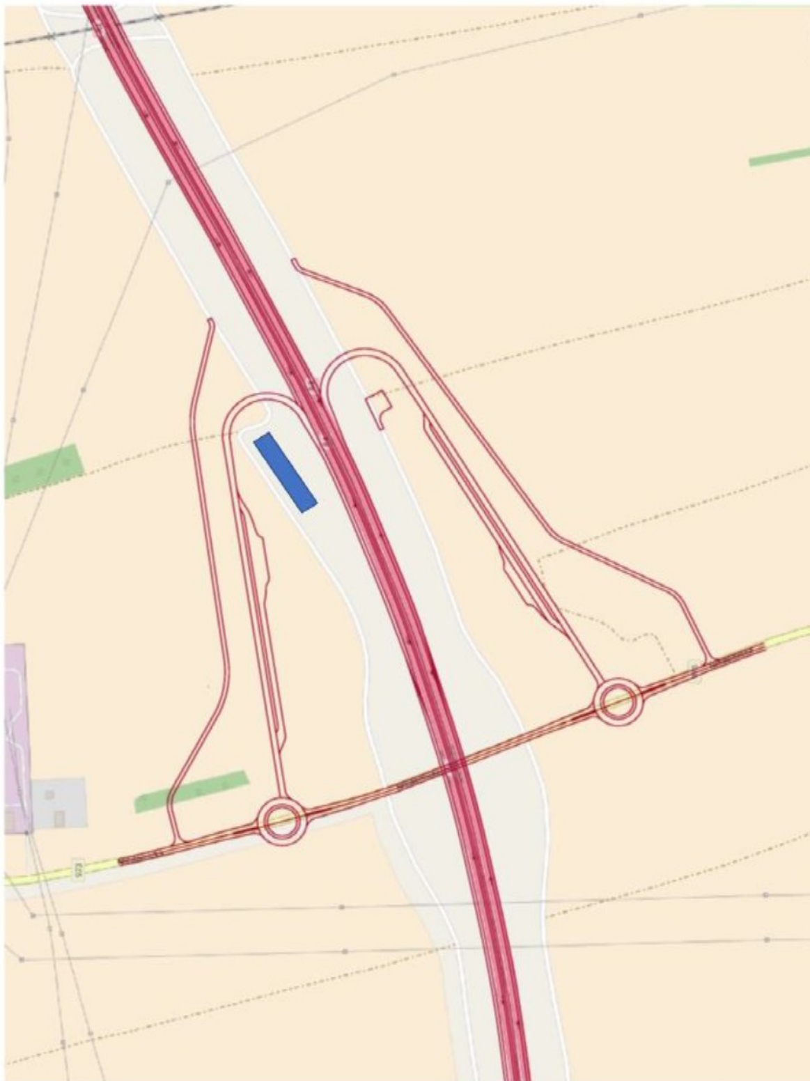
Rys. 3.3. Węzeł typu WB harfa z rondami – niepełne relacje
