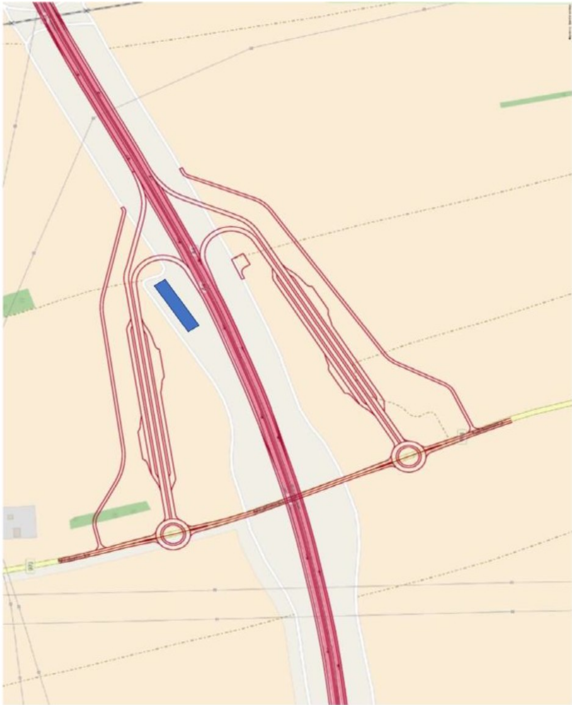
Rys. 3.2. Węzeł typu WB harfa z rondami
